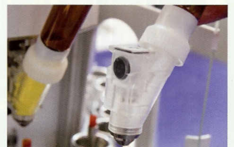
RFID-chip in de doseerkop van de Quantos weeg- en doseerunit van Mettler-Toledo zorgt voor draadloze uitlezing en opslag van monstergegevens.
